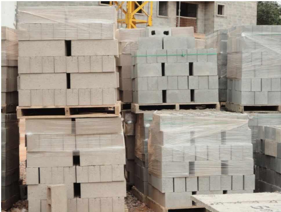
Construtora A - Blocos pré-moldados. Alvenaria estrutural.
